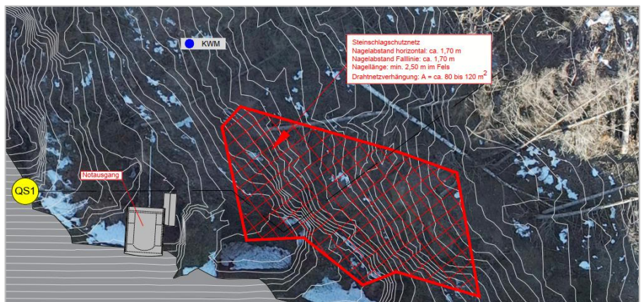
Auszug aus einem Bauwerksplan mit von einer Drohne erzeugtem hinterlegtem DGM
